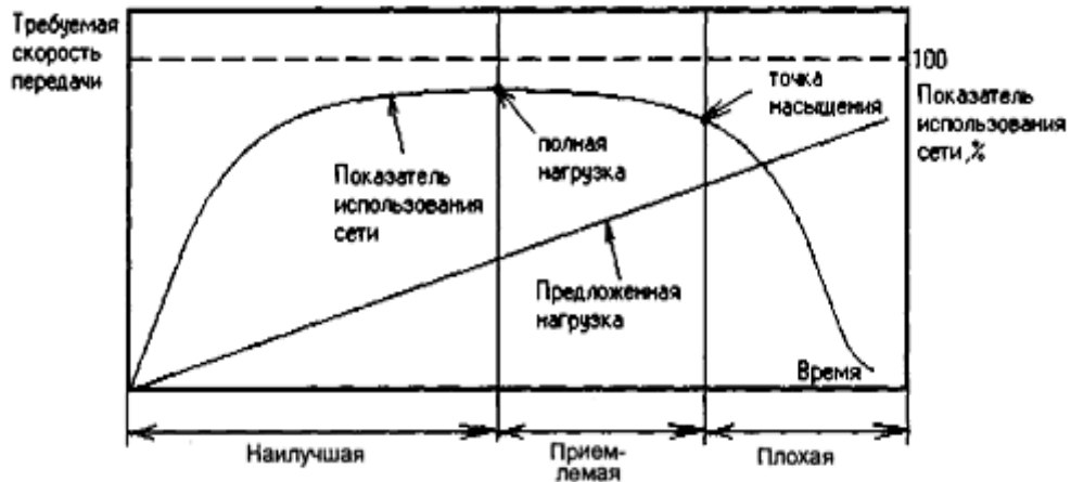
Рисунок 2.7 - Зависимость показателя использования сети от величины полезной нагрузки
