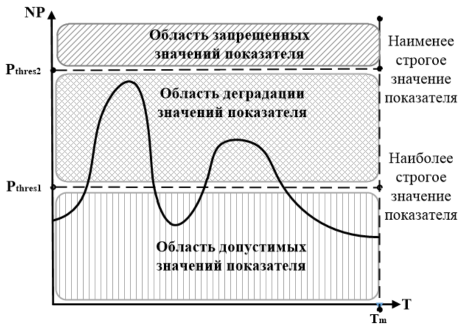
Рисунок 2.3 - Области значений показателя сетевой производительности (NP)
