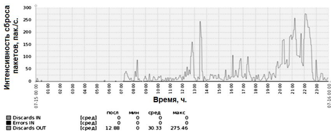
Рисунок 4.10- График интенсивности сброса пакетов данных в пакетной очереди сетевого соединения с использованием РРЛ
