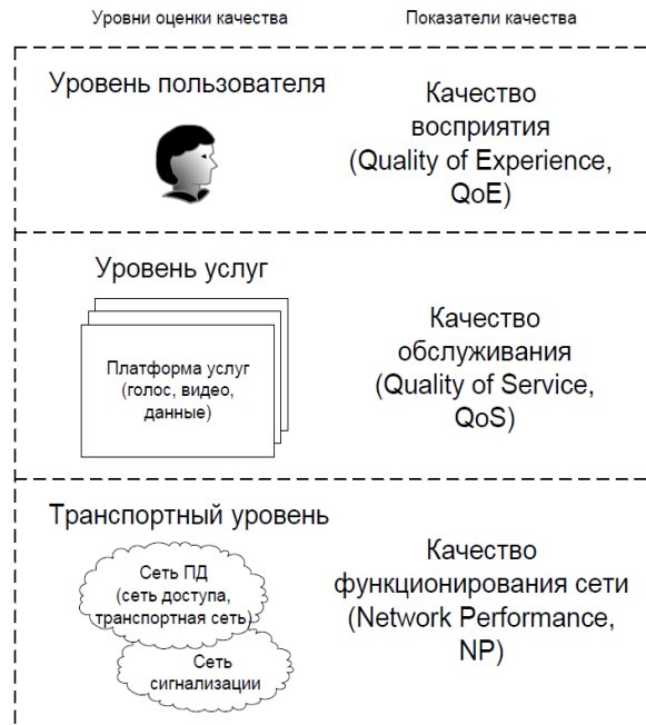
Рисунок 1.9 - Распределение показателей качества услуг связи по технологическим системам
