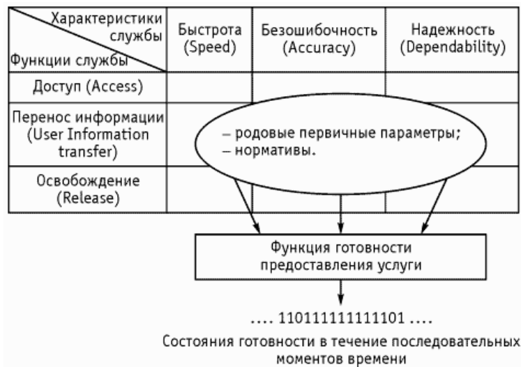
Рисунок 1.11 - Матрица для оценки QoS и NP сетевого соединения
